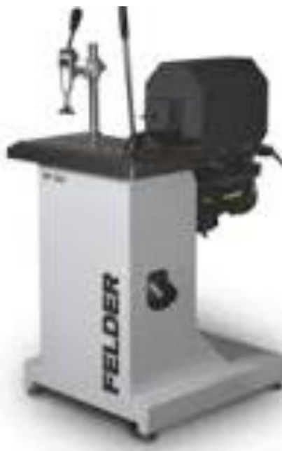
Рис. 2.5. Свердлильно-пазувальний верстат Felder FD 250 [24]
