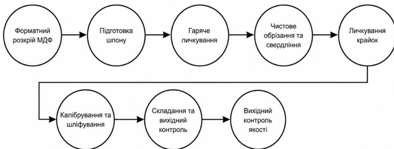
Рис. 2.2. Технологічний процес виготовлення личкованих конструкційних елементів
