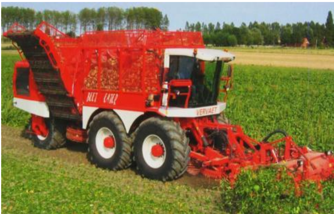
Рис. 3.10. Бурякозбиральний комбайн Vervaet Beet Eater 625 в роботі
