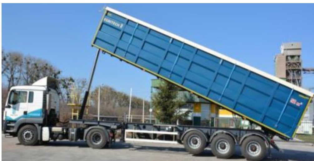
Рис. 2.2. Автотягач MAN зі змінним напівпричепом-самоскидом НПС-2650
