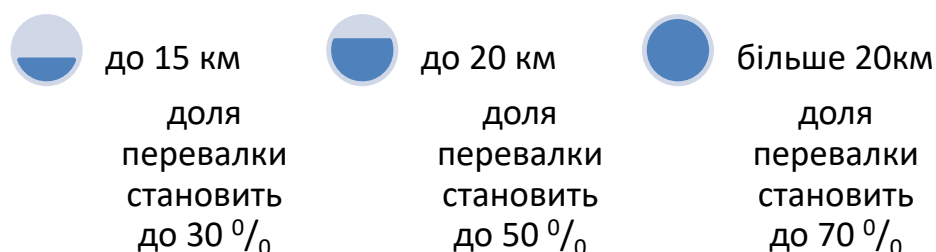
Рис. 3.7. Принципова схема залежності відсотку перевалки обсягу зібраних коренеплодів від відстані перевезень
