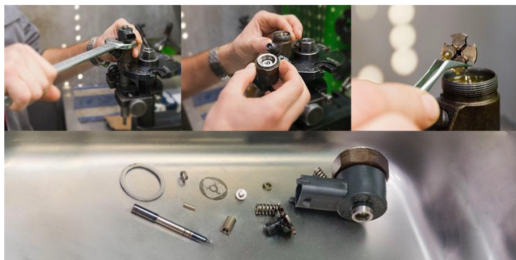
Рисунок 1.2 – Послідовність демонтажу форсунки [17]
