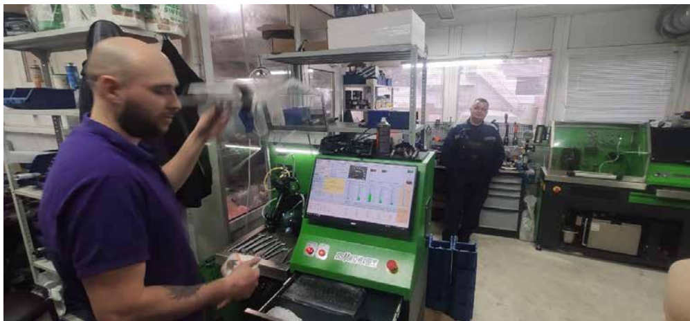
Рисунок 1.4 – Станція діагностики, очищення та калібрування форсунок, перевірки параметрів рейки
