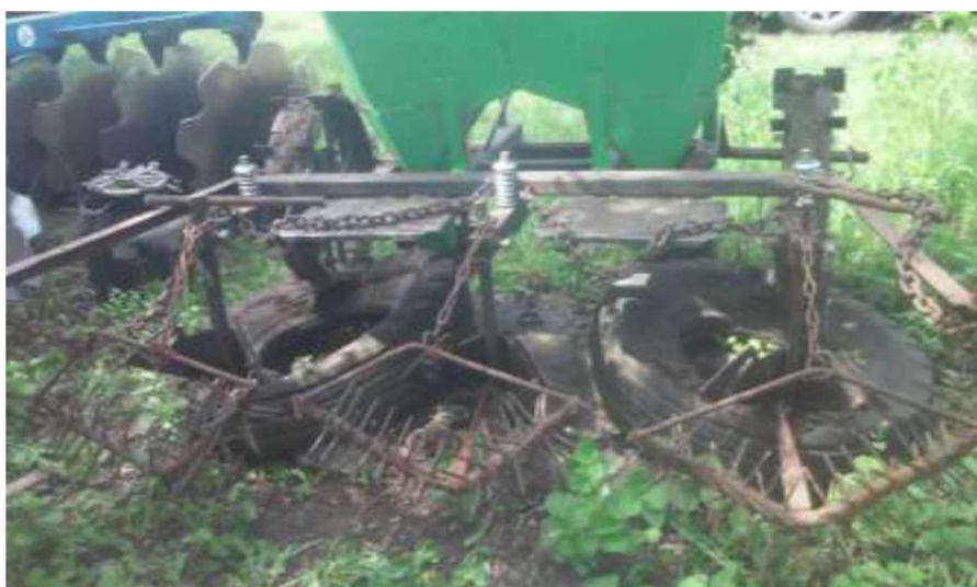
Рис. 3.11 - Комплектування картоплесаджалки типу КС-2 барабано-роторними голчастими боронувальними робочими органами.
