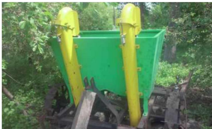
Рис. 3.10 - Загальний вид використаної картоплесадильної навісної сільськогосподарської машини типу КС-2.
