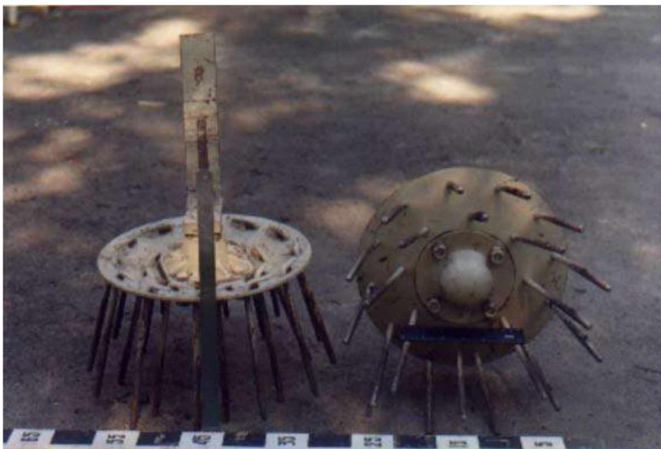
Рис. 3.13 - дискові голчасто-стрижневі борони, виготовлені в ННЦ ІМЕСГ НААНУ.
