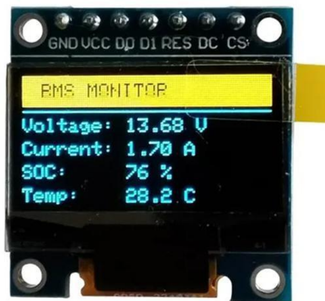
Рис. 2.4 – Зовнішній вигляд OLED дисплею 0.96" 128×64 для Arduino
