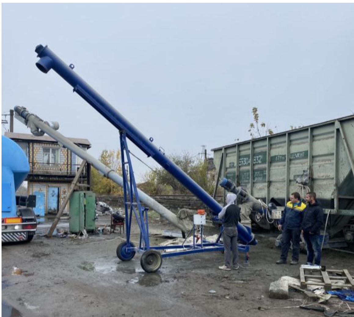
Рис. 3.12. Незадовільна координація дій вантажників в процесі перевантаження зерна
