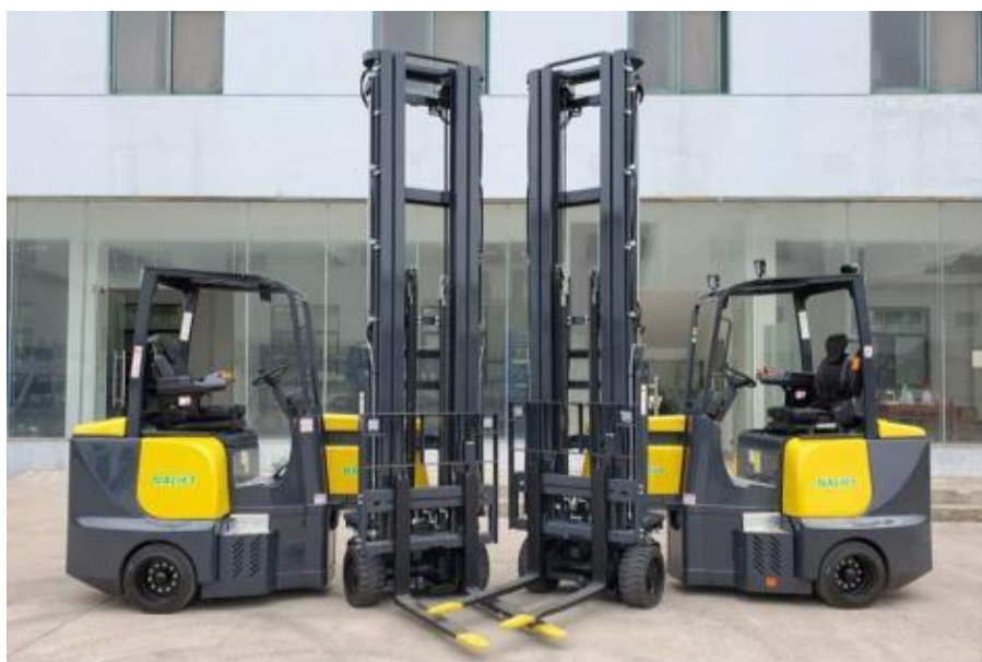
Рис. 5.6. Можливість зіткнення навантажувачів при ступінчастій розстановці АТЗ
