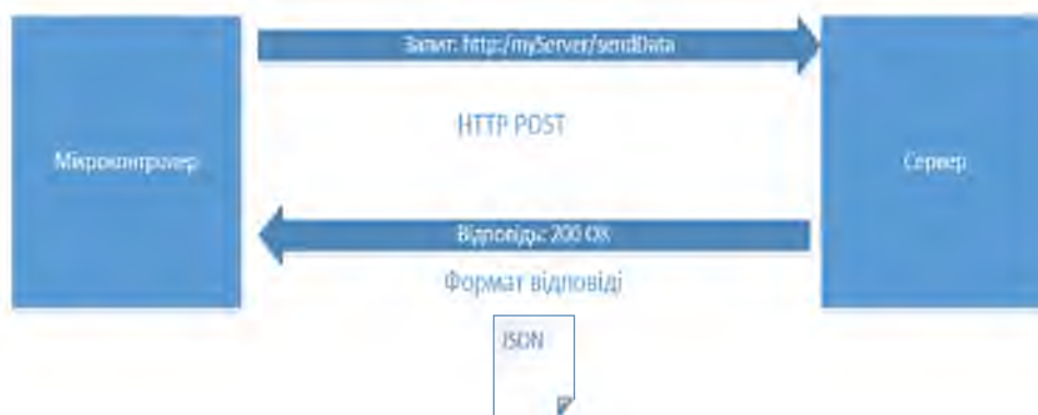
Рис. Схема взаємодії мікроконтролера з сервером
