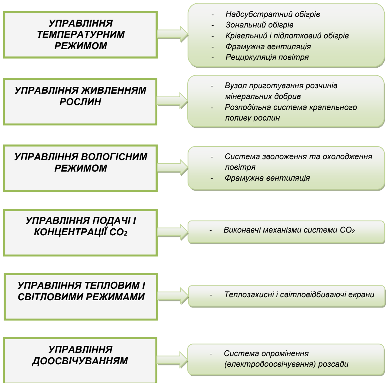
Рис. 2.6. Поділ технологічного обладнання на системи, що забезпечують підтримку показників мікроклімату
