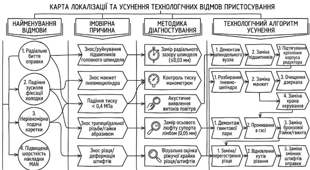
Рисунок 3.5 – Унаочнення локалізації та усунення відмов пристосувань ремонту гальмівних систем
