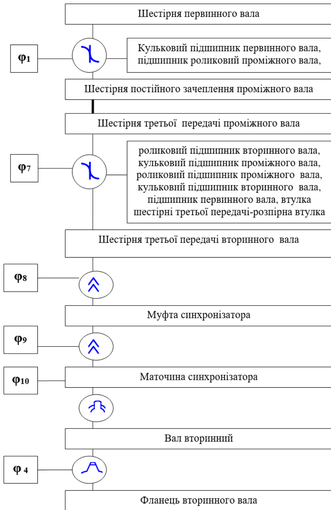
Рис.2.8 Структурна модель контактів деталей при ввімкненні третьої передачі
