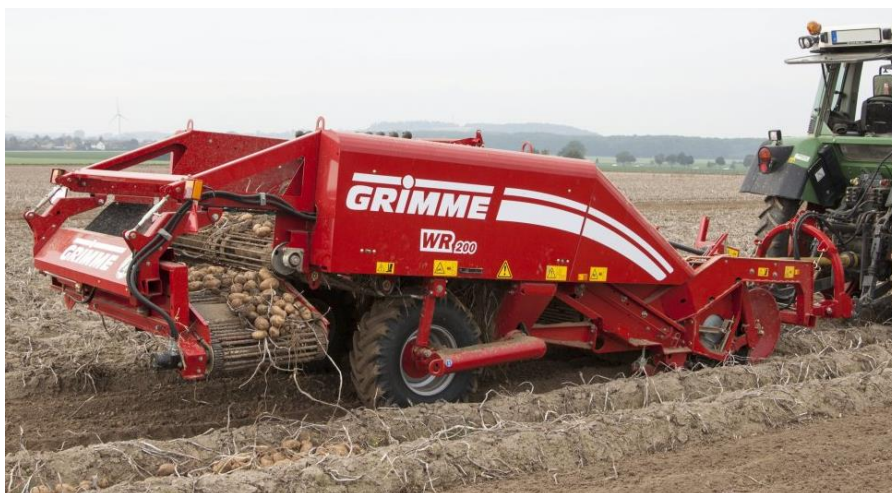
Рис. 2.18. Дворядні картоплекопачі-валкоукладачі Grimme WR 200 з центральним або бічним укладанням бульб у валки
