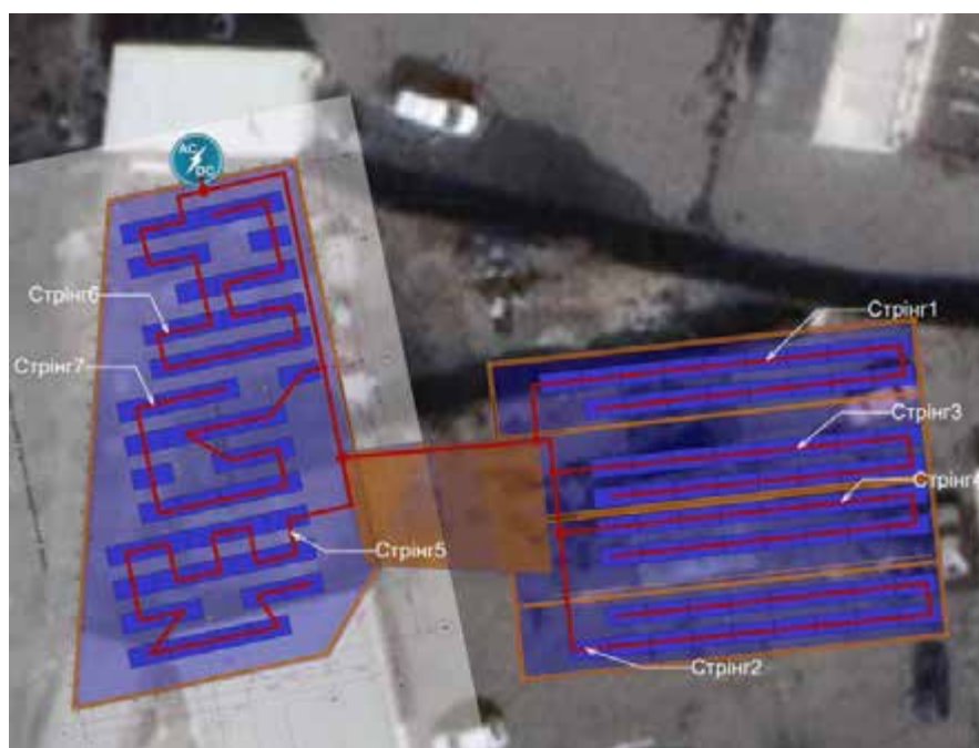
Рис.3.2. Схема стрінговки панелей
