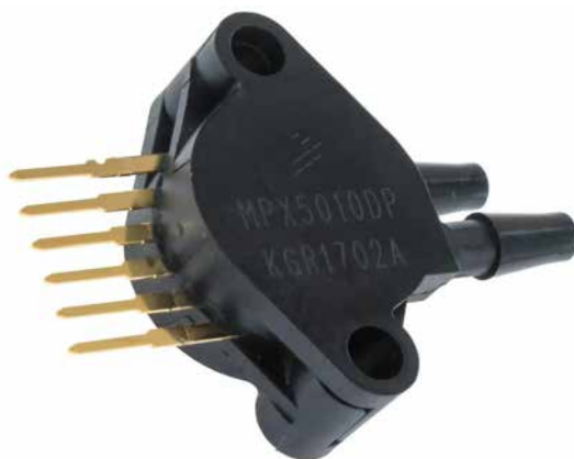
Рис.3.18 Диференційний датчик тиску MPX5010DP
