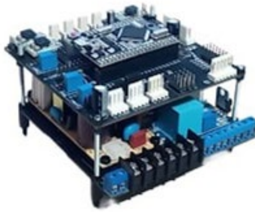
Рис.3.6 Контролер на базі контролера Arduino Mega2560 Pro
