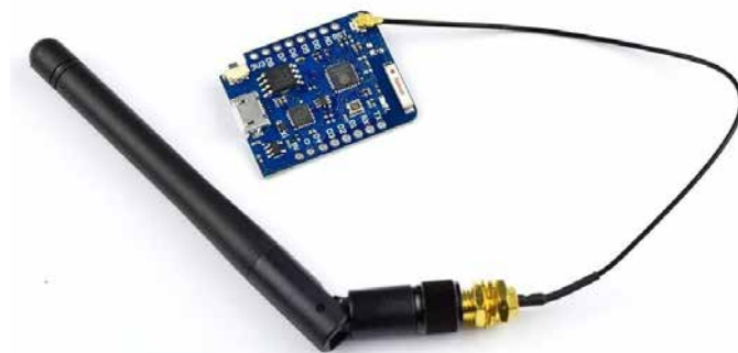
Рис.3.7 Мікроконтролер Weemos d1 mini
