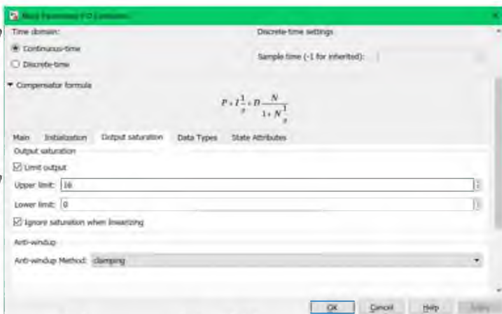
Рисунок 3.2.3 – Вікно властивостей блоку ПІД-регулятора
