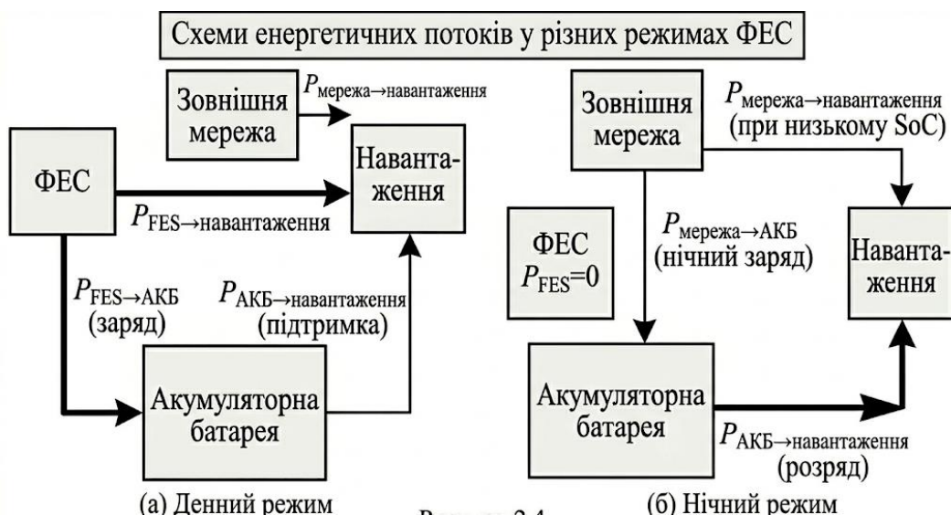
Рис. 2.3. Потоки енергії в комбінованій системі живлення в денний та нічний періоди доби.
