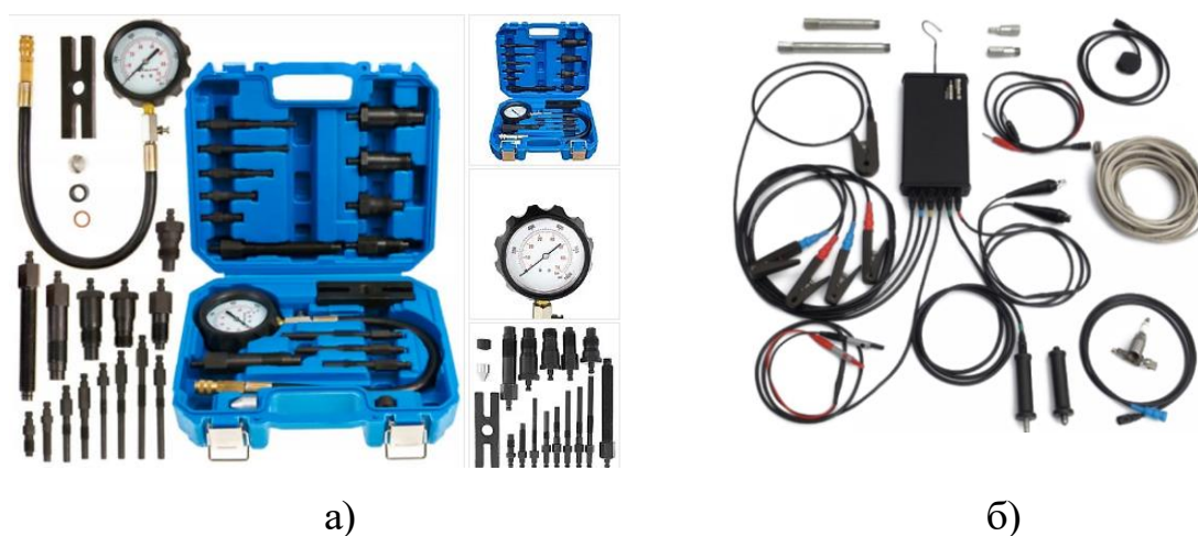
Рис. 3.3. Комплект приладів для експерименту з картерними газами двигунів зернозбиральних комбайнів
