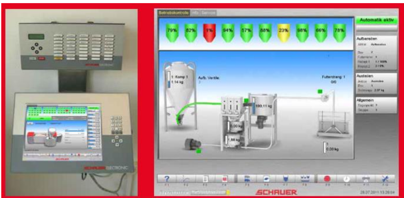
Рис. 6.31. Система порційної годівлі Spotmix II (Schauer), [172]
