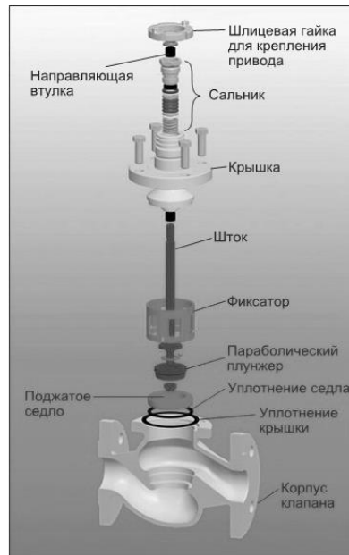
Рис. 3.7. Основні частини регулюючого клапана
