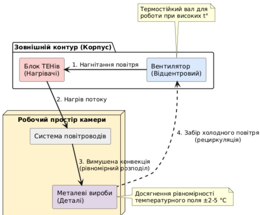
Рис. 1.2. Схема системи нагріву та термоізоляції камери
