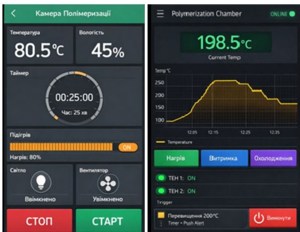
Рис. 3.5. Інтерфейс мобільного додатку Blynk IoT для моніторингу та керування камерою полімеризації
