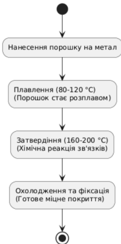
Рис. 1.1. Технологічний процес полімеризації порошкового покриття
