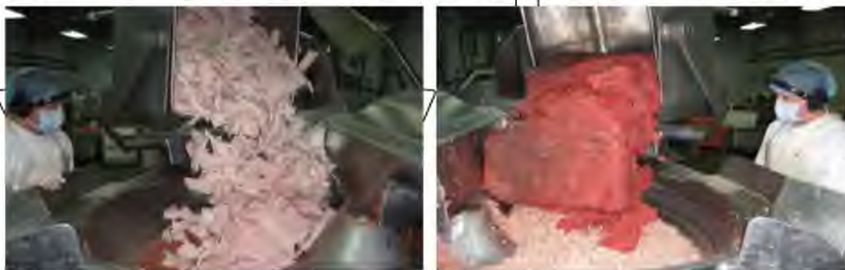
Рис. 12. Закладка та подрібнення шпику хребтового
