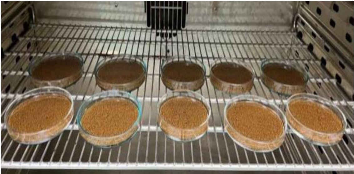
Рисунок 2.2 Висушування корму «Nutra Olympic» 1.5 мм, який попередньо був забруднений розчином ^{137}\text{Cs}
