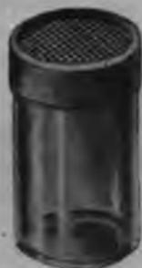
Рис. 76. Пробирка съ металлической сѣткой.
