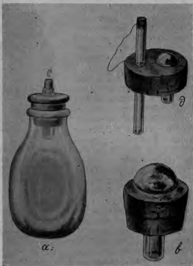
Рис. 70. Плоская банка для умерщвления насекомыхъ (а); пробка съ стеклянной трубкой и шарикомъ (b); пробка съ стеклянной трубкой, открытой съ обоихъ концовъ (с); пробка съ двумя стеклянными трубками (d).
