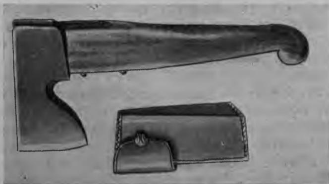
Рис. 68. Энтомологическій топоръ; внизу—футляръ для лезвія.
