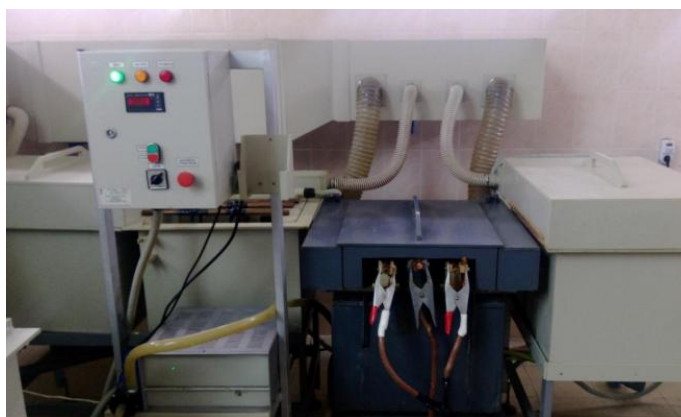
Рис. 4.4. Установка для нанокomпозиційного електролітичного хромування
