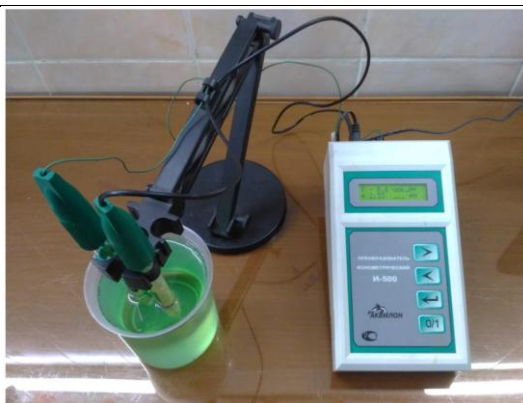
Рис. В4 Іонометричний перетворювач І- 500120
