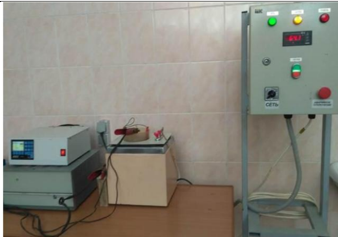
Рис. В2. Лабораторна гальванічна установка
