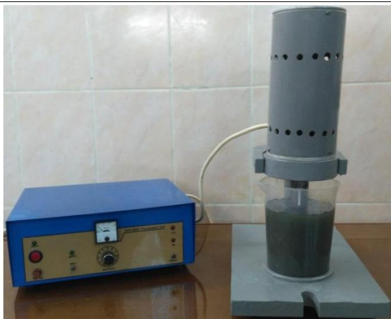
Рис. В1. Ультразвуковий генератор УЗГ-2М116
