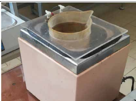
Рис. В3.. Ультразвукова ванна УЗП 0,25
