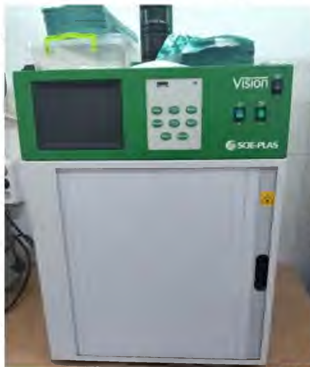
Рис. 2.7 Система для гелю-документації VISION Gel (візуалізація результатів)
