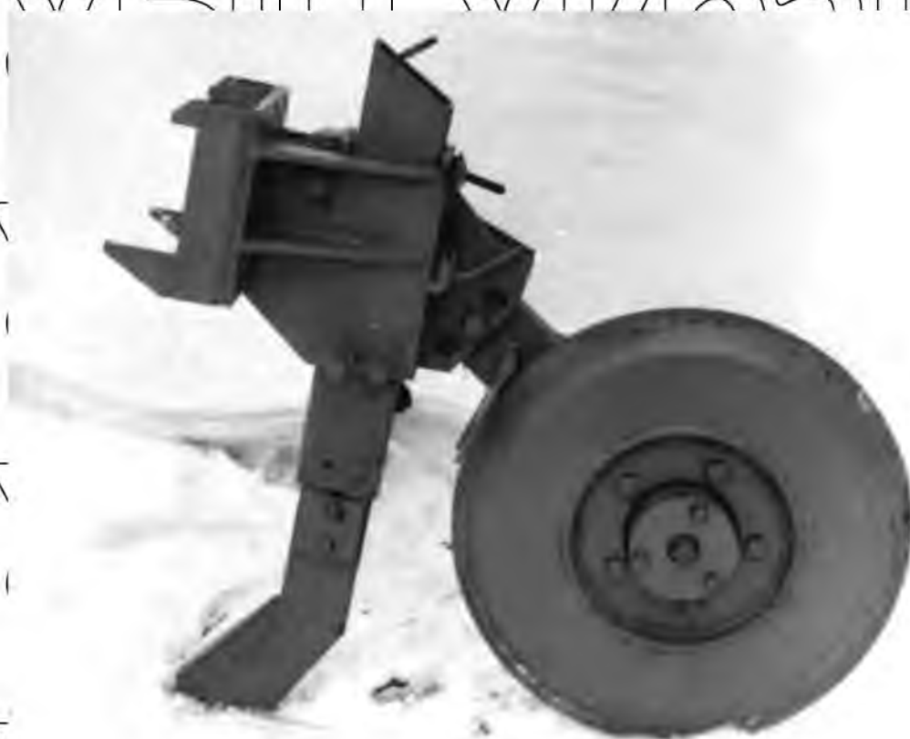
Рисунок 3.1 – Схема просапного культиватора обладаного механічним орієнтатором
