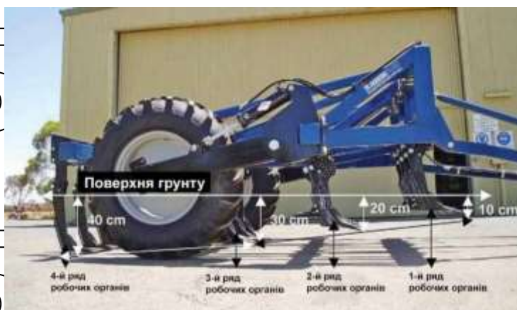
Рис 1.8 Встановлення окремих долот на коротких стійках в лінію попереду основних робочих органів
