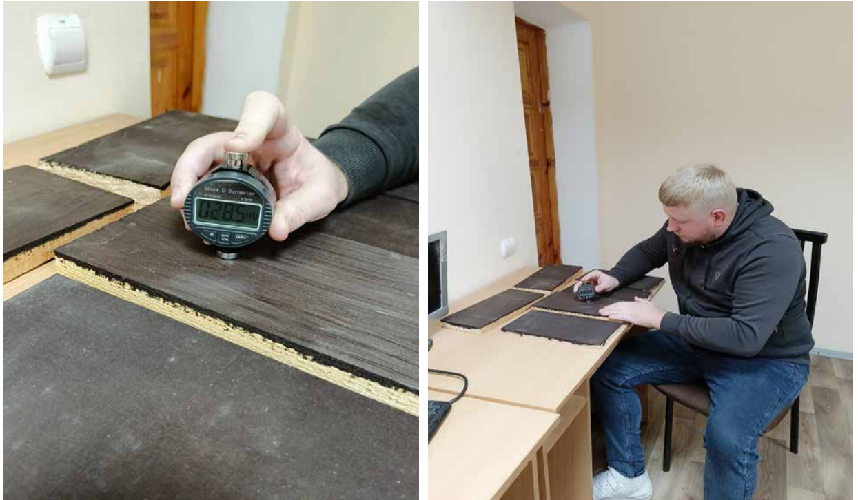
Рис.4.9. Визначення твердості цифровим твердоміром (дюрометром)
