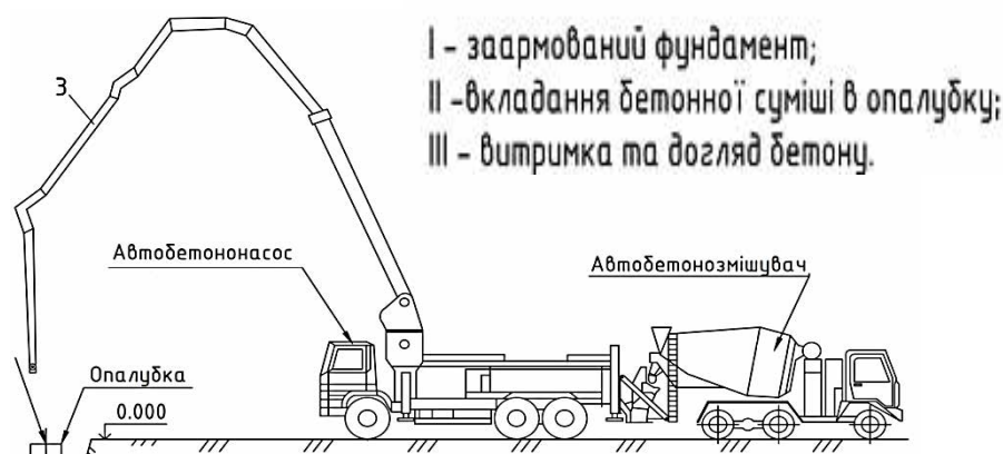
Рис. 4.4. Перекачування бетонної суміші в опалубку фундаментної плити
