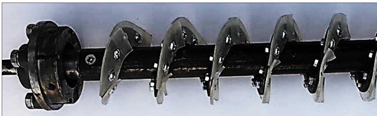
Рис. 2.17. Секційна еластична спіраль (матеріал «поліуретан PU-60»), що закріплена на жорсткому гвинтовому ребрі
