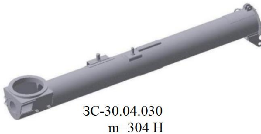
Рис. 2.9. Загальний вигляд кожуха універсального завантажувача насінневих матеріалів ЗС-30М
