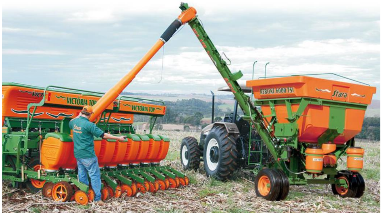
Рис. 1.1. Універсальний агрегат при завантаженні сівалки
