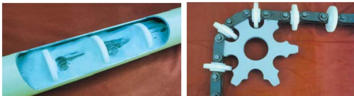
Рис. 1.10. Робочий орган шайбового конвеєра
