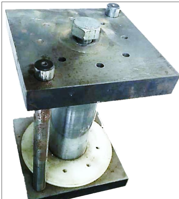
Рис. 2.13. Кондуктор для свердління спіралі шнека, що навіта на ребро
