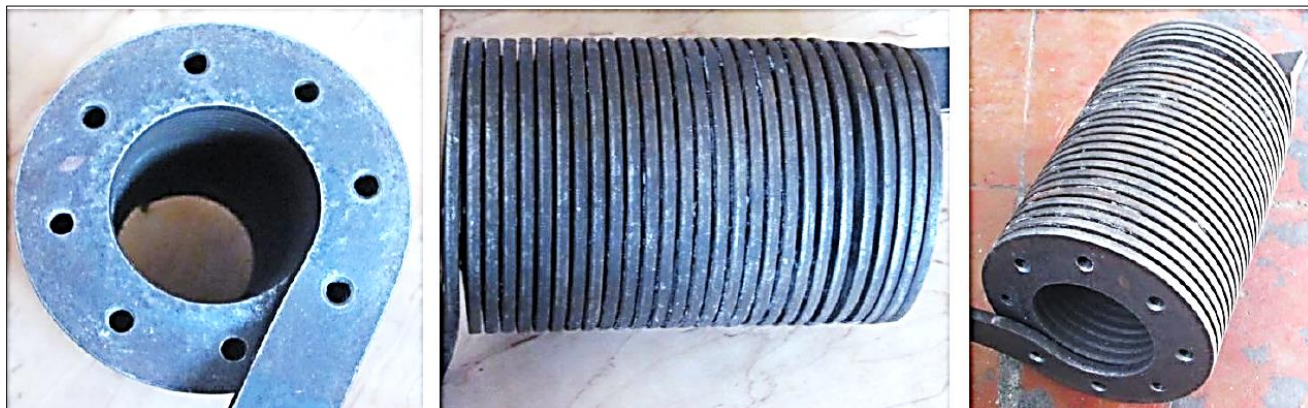
Рис. 2.14. Загальний вигляд навитої на ребро спіралі з виконаними отворами
