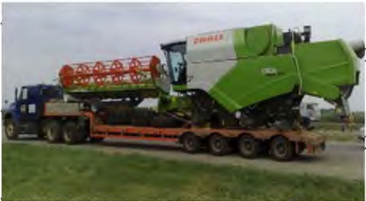
Рис. 2.3. Спосіб перевезення негабаритних вантажів низькорамним траком-напівпричіпом на прикладі зернозбирального комбайна
