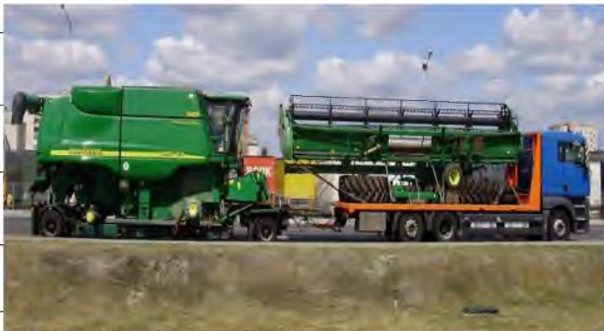
Рис. 2.4. Спосіб перевезення негабаритних вантажів за допомогою триланкового автопоїзда на прикладі комбайна Джон Дір
