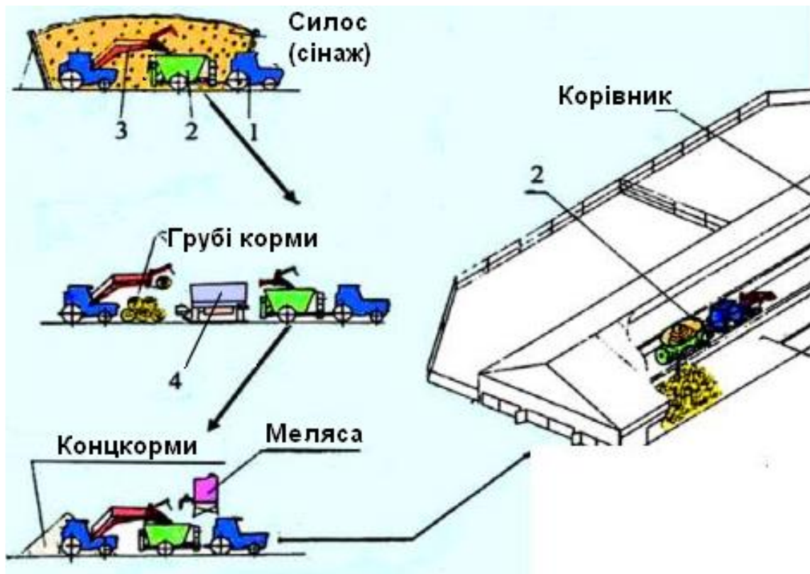
Рис. 2.2. Лінія приготування кормів з використанням мобільних подрібнювачів-змішувачів-роздавачів: 1 – трактор МТЗ-80/82; 2 – мобільний подрібнювач-змішувач-роздавач; 3 – фронтальний навантажувач ПКУ-0,8; 4 – подрібнювач грубих кормів.
