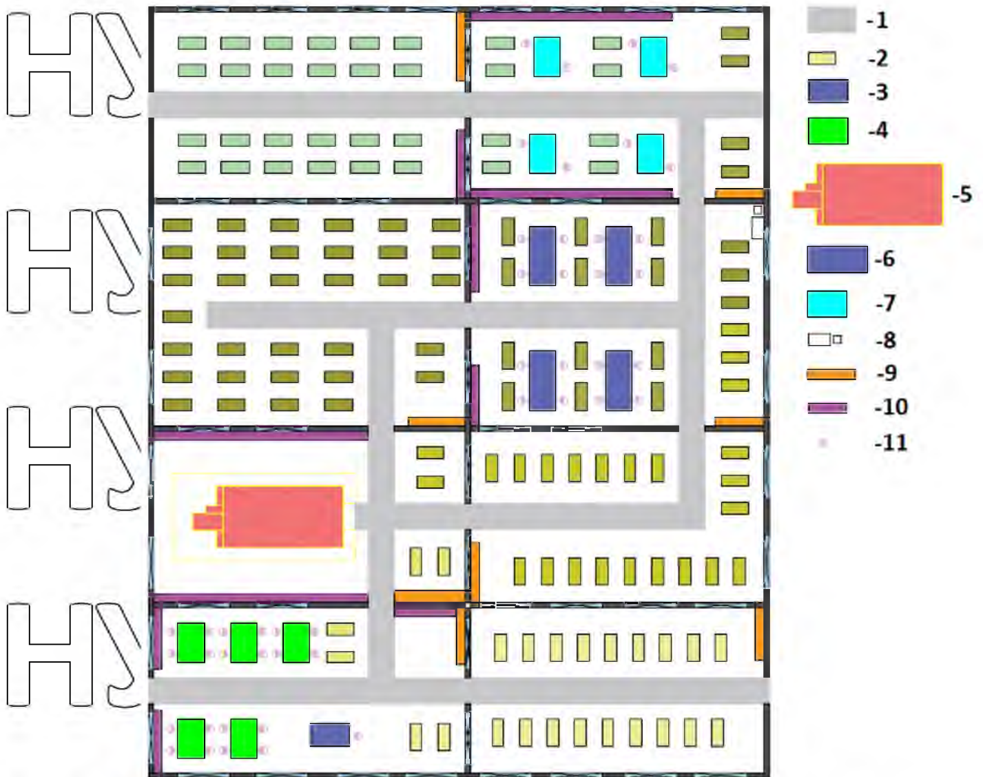
Рис. 4.3. Схема дільниці для опорядження стелярних виробів масловосками на ПП «Меблева фабрика «Мірт» з умовними позначеннями обладнання: 1-проїзд/прохід; 2-стелаж заготовок на колесах; 3-шліфувальний станок; 4-шліфувальний стіл; 5-камера для фарбування; 6-стіл для контролю якості опорядження; 7-стіл для пакування; 8-робочий стіл; 9-стіл пожежної безпеки; 10-шафа для зберігання робочих матеріалів; 11-працівник
