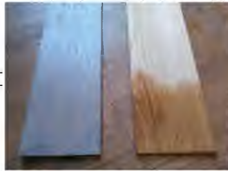
Рис. 3.2. Зразки після перебування у воді на протязі години: зліва ламель, покрита масловоском, справа – нічим не оброблена ламель
