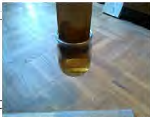
Рис. 3.3. Зразок №1 не оброблена ламель дубу, після перебування у воді на протязі 24 годин
