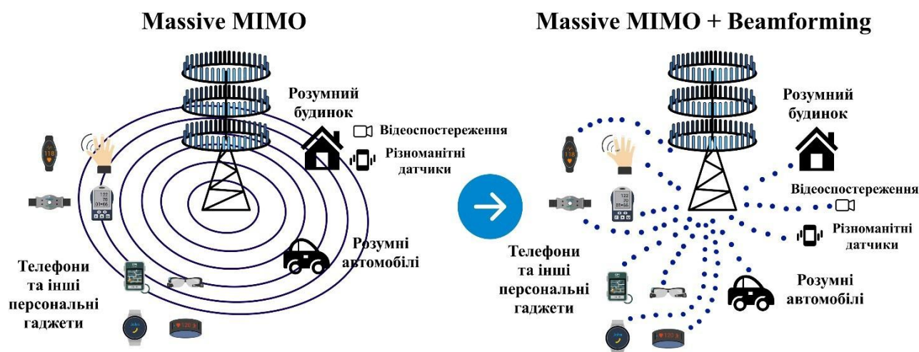
Рис. 3.5 Схематичне зображення роботи Massive MIMO та Massive MIMO у поєднанні з технологією Beamforming.
