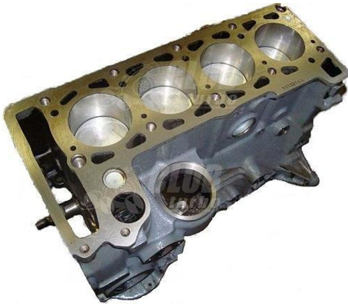
Рис. 1 - Монолітний чавунний блок ВАЗ 2121
