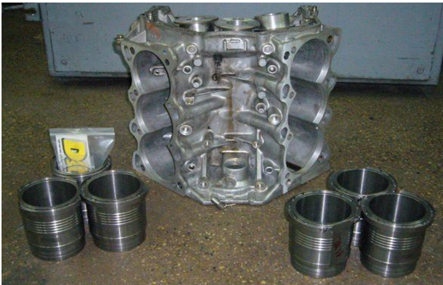
Рис. 2 - Чавунний блок зі знімними гільзами
