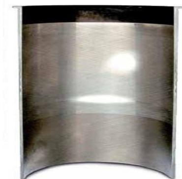
Рис. 4 - Нерівномірний знос робочої поверхні. Отвори циліндра мають ознаки нерівномірного зносу в вигляді
