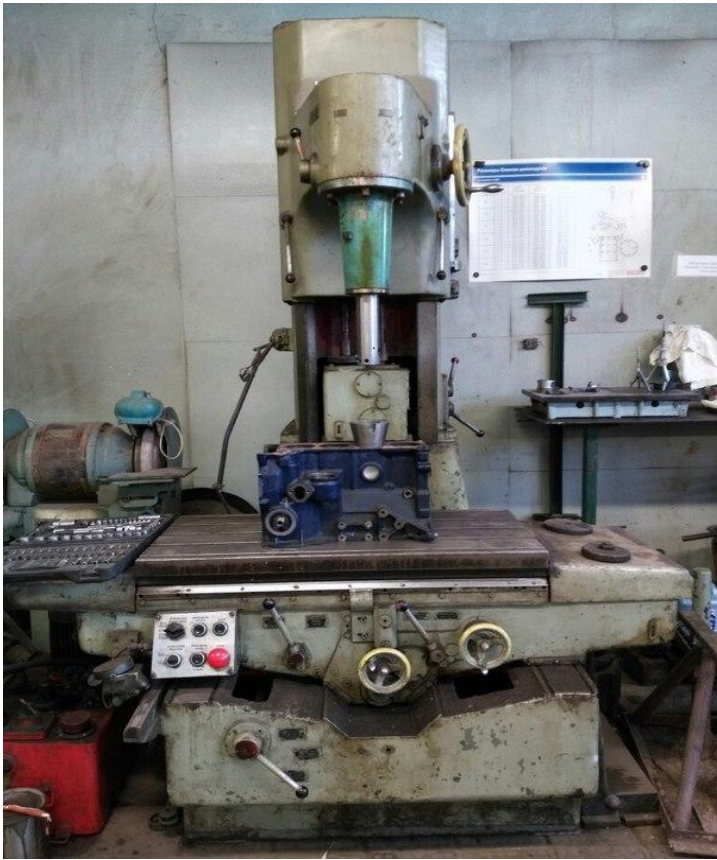
Рис. 8 - Вертикально - розточувальні верстат 2E78П Таблиця 4 - Технічна характеристика верстата 2E78П
