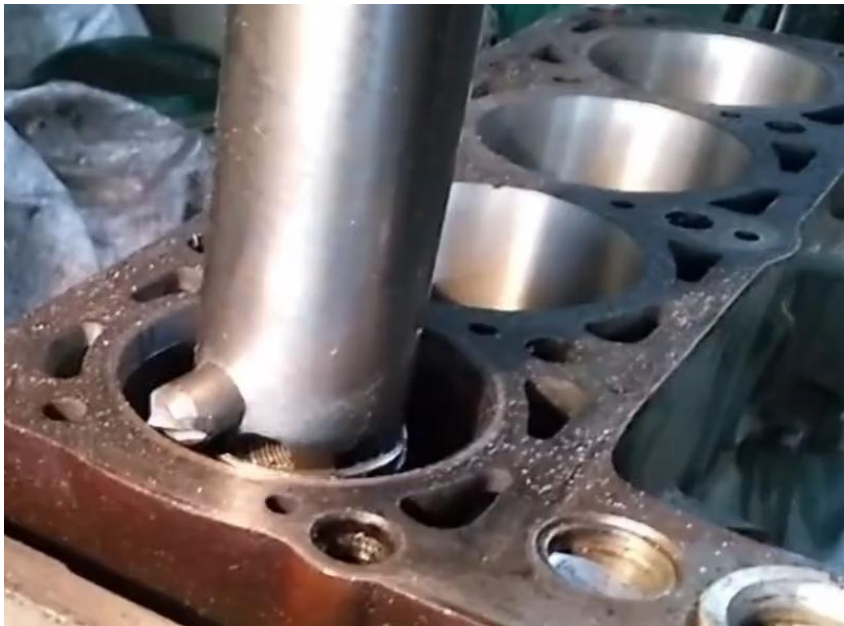
Рис. 19 - Встановлення різця і процес розточування
