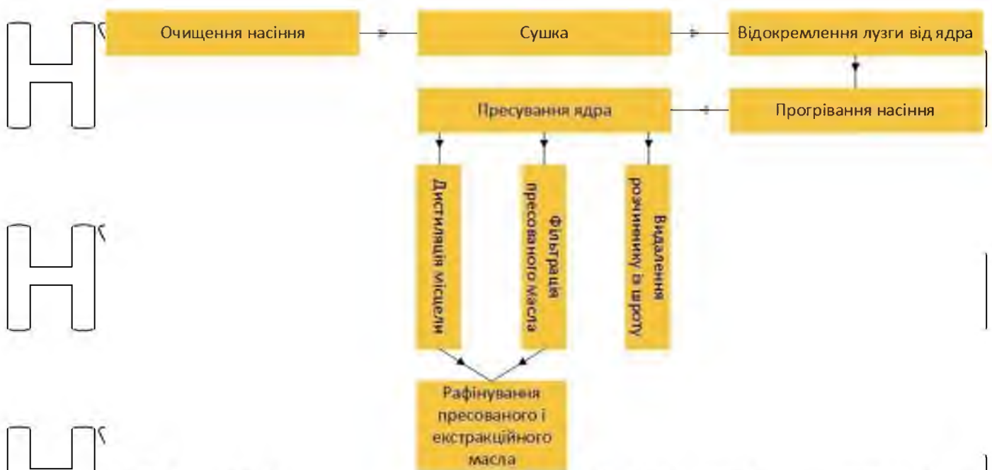
Рисунок 2.3 – Принципова схема екстракції соняшникової олії
