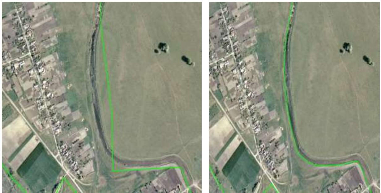
Рис. 8.6. Приклад помилки розташування межі кадастрової зони та її корегування при створенні індексних кадастрових карт
