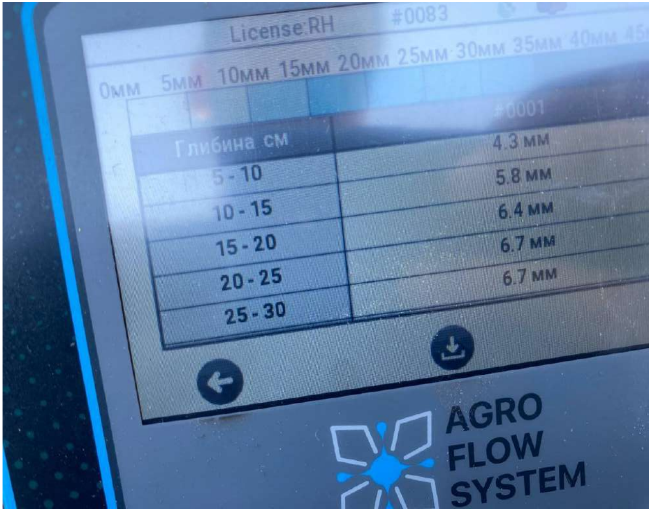
Рисунок 4.5. Заміри вологості ґрунту (заміри були зроблені 15.07.2024)
