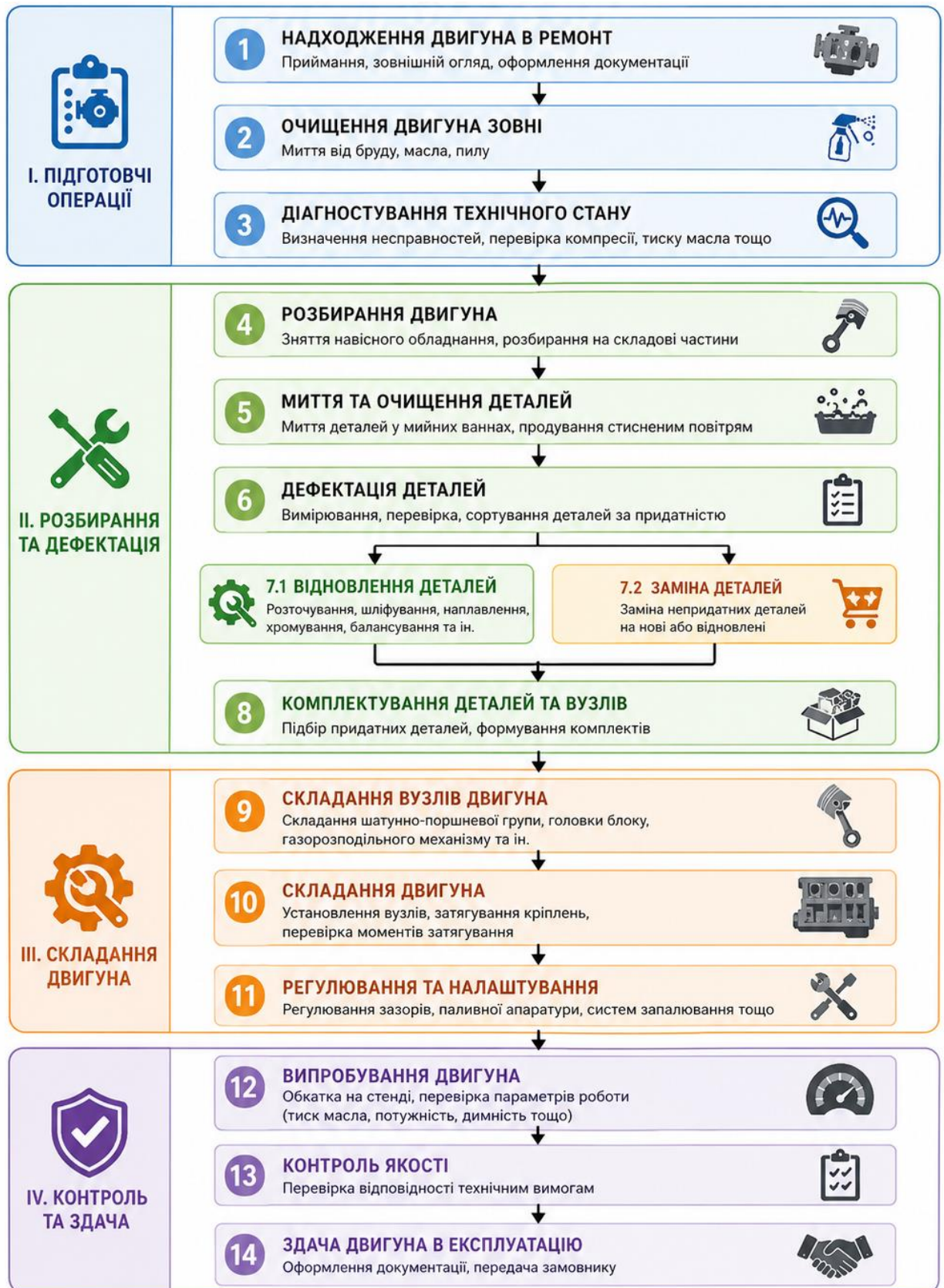
Рис. 2.1 – Схема загального технологічного процесу ремонту двигуна
