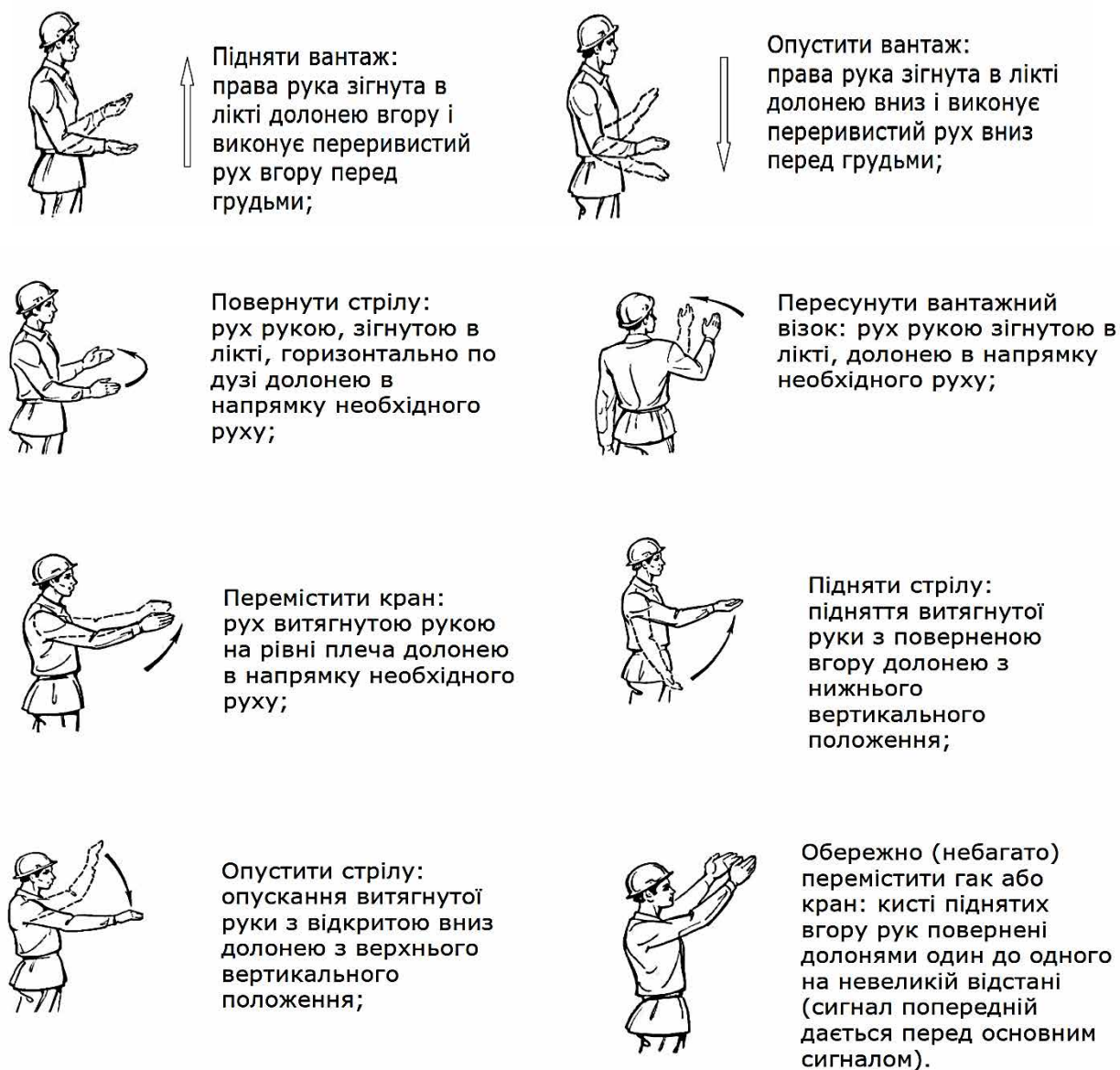
Рис. 6.1. Обумовлена знакова сигналізація при переміщенні вантажів краном
