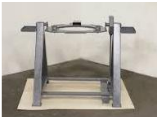
Рис.3.3 Установка для розбирання та складання передніх та задніх мостів автомобілів Б252АМ
