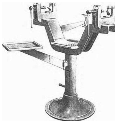
Рис. 3.2 Стенд для розбирання та складання мостів вантажних автомобілів ЗІЛ, МАЗ, КАМАЗ, середнього та великовантажного класу (мод. 2450)
