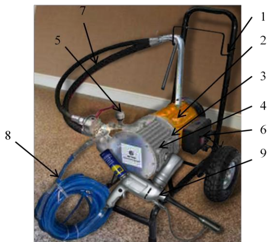
Рис. 3.19. Установка для нанесення багатокомпонентного розчину
