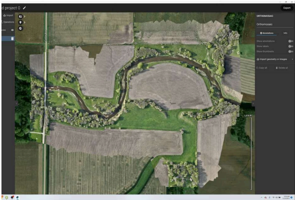
Рис.Д - ортофотоплан, створений у результаті обробки аерофотознімків, отриманих з безпілотного літального апарата DJI Mavic 3 Multispectral. Ортофотоплан відображає структуру землекористування та використовується для аналізу меж і складу земель поза межами населеного пункту села Комишувате Рівненської територіальної громади.
