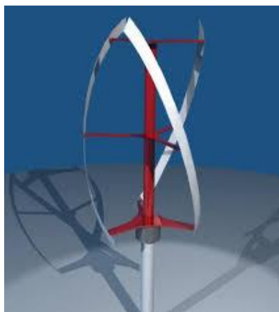
Рис.2.4. Конструктивна схема ВЕУ з вертикальною віссю обертання
