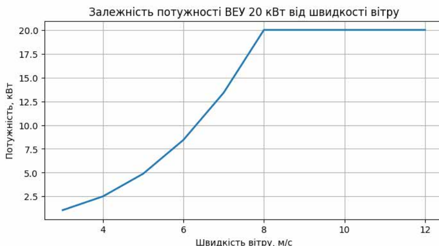
Рис.2.6. Залежність потужності вітроустановки від швидкості вітру
