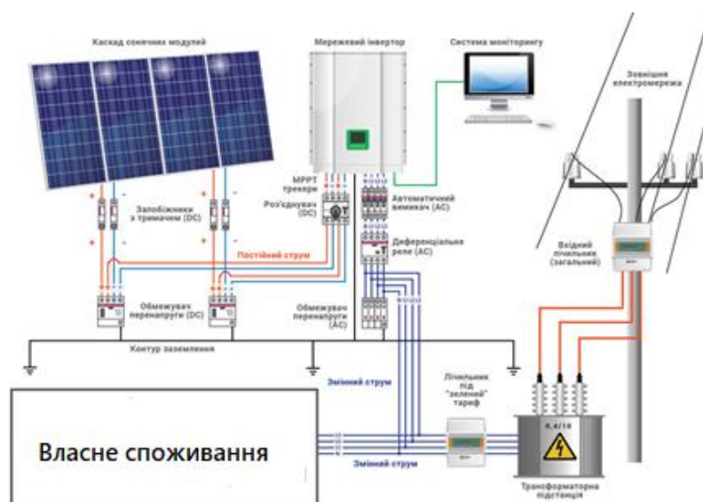
Рис. 2.2. Схема роботи сонячної електростанції
