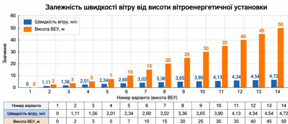
Рис. 1.2. Залежність швидкості вітру від висоти розташування ротора вітроенергетичної установки
