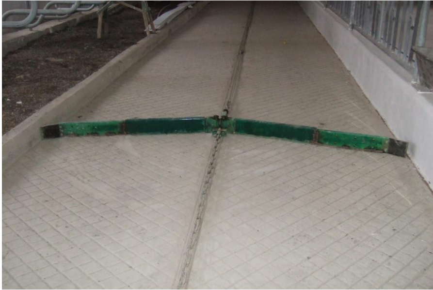
Рис. 1.6. Скреперна установка УСГ-3
