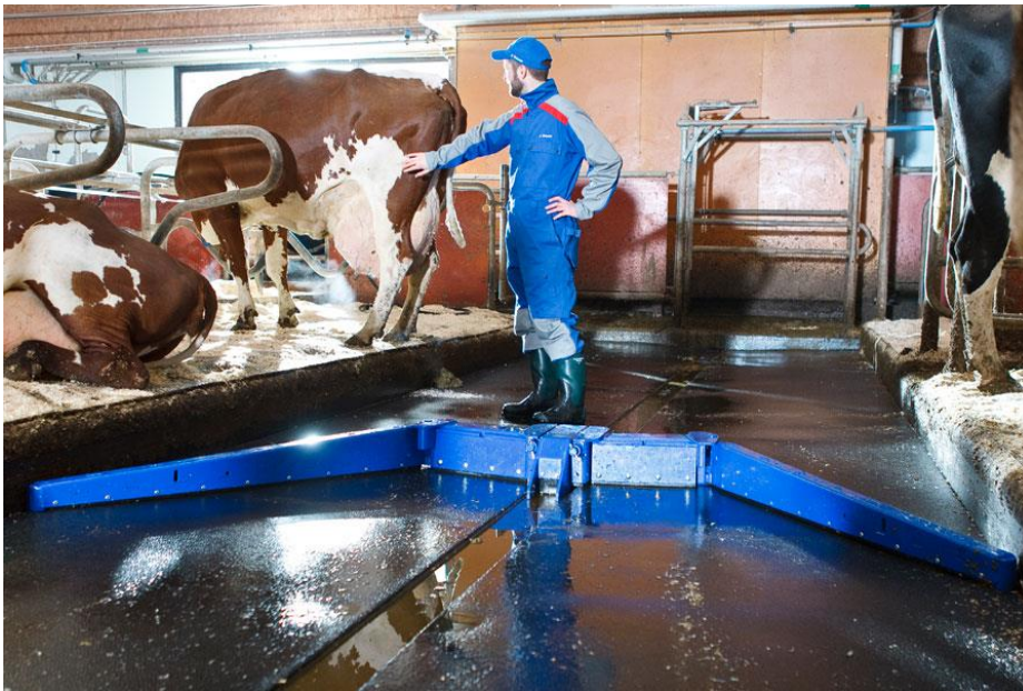
Рис. 1.9. Дельта-скрепер DW компанії Де Лаваль (Швеція)
