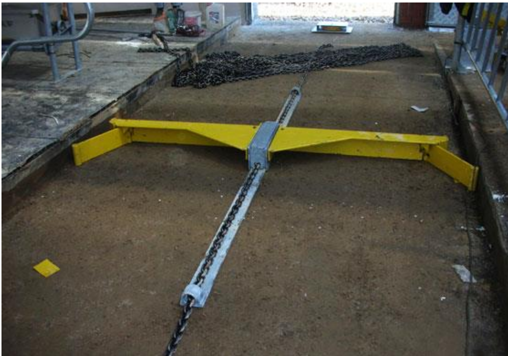
Рис. 1.12. Установка дельта-скреперна гноєзбиральна, підприємства Нові Агро Технології (НАТ)
