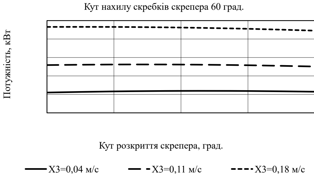
Рис. 4.29. Залежність споживаної потужності електродвигуна приводу удосконаленої скреперної установки від кута розкриття скрепера
