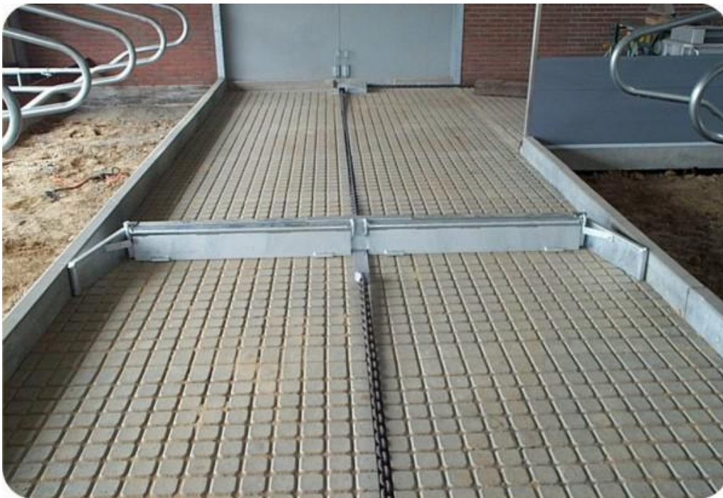
Рис. 1.10. Комбіскрепер виробництва голландської компанії JOZ
