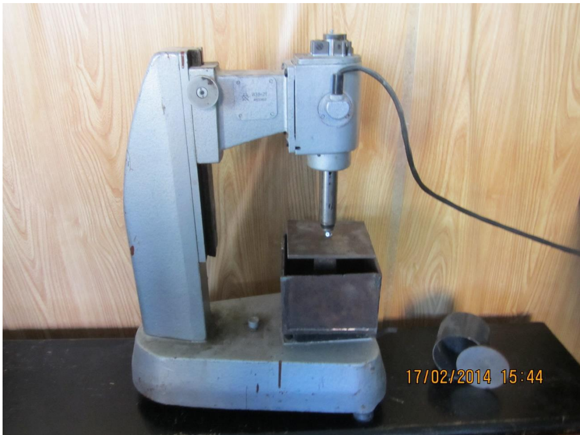
Рис. 3.21. Прилад для визначення липкості гною ИЗВ-21
