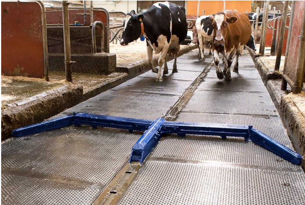
Рис. 1.8. Гідравлічний скрепер DML компанії ДеЛаваль (Швеція)
