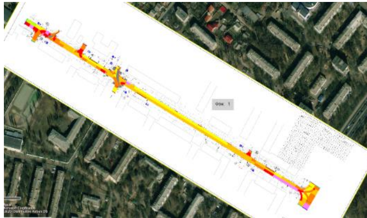
Рисунок 3.9. Графік середньої швидкості проєктного стану потоку в PTV Vissim.
