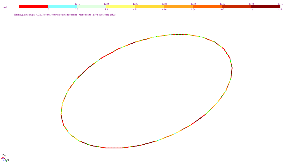
Рис. 4.20. Нижнє армування по кутах залізобетонного ригелю
