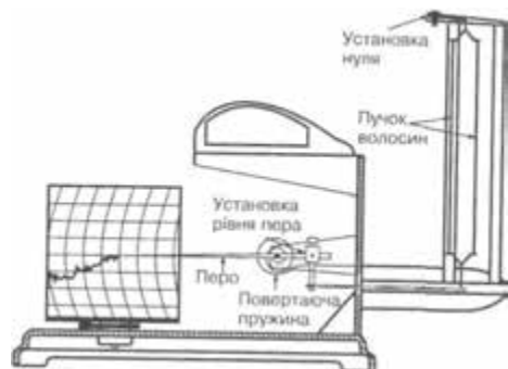
Рис. 1.5.5. Схема гігрографа
