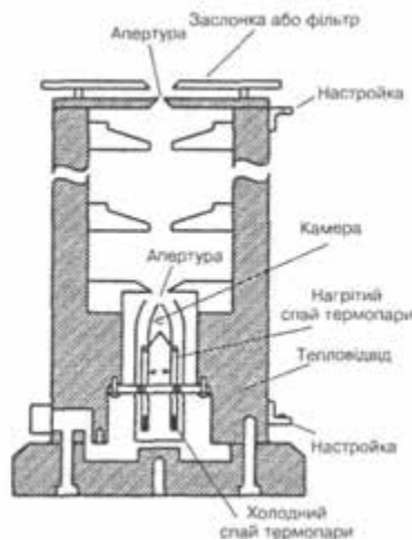
Рис. 1.8.7. Конструкція піргеліометра
