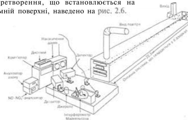
Рис. 2.6. Схеми приладу для аналізу забруднення атмосфери, що працює на основі Фур'є спектроскопії
