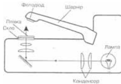
Рис. 1.9.6. Оцінка почорніння плівки за допомогою денситометра
