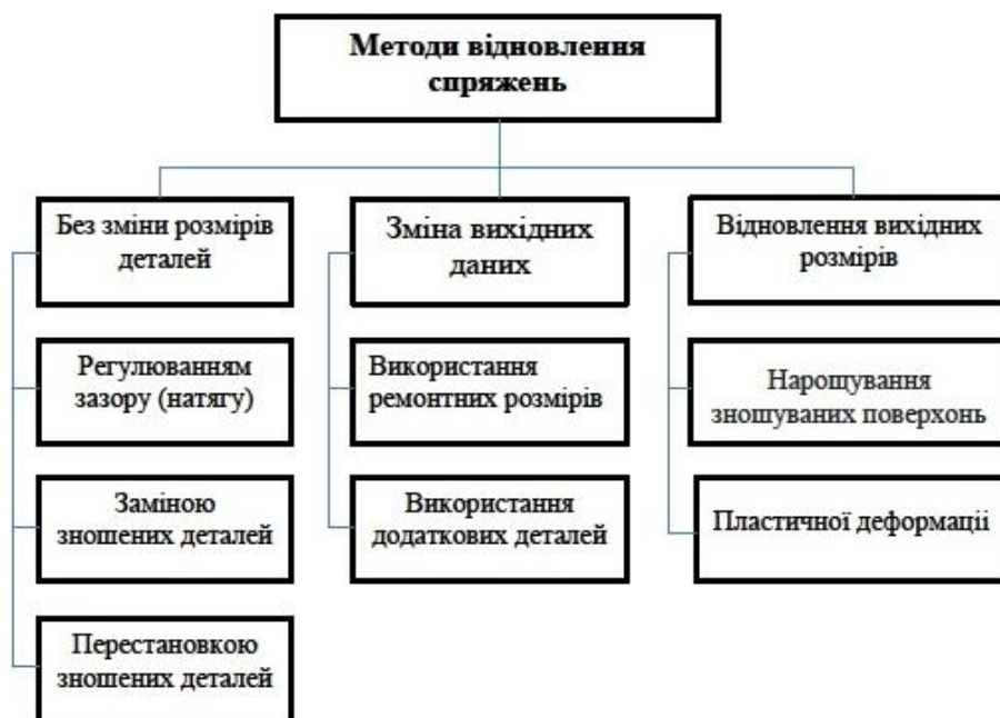
Рис. 1.6. Методи відновлення працездатності з'єднань «диск – прокладка» пневматичних сівалок
