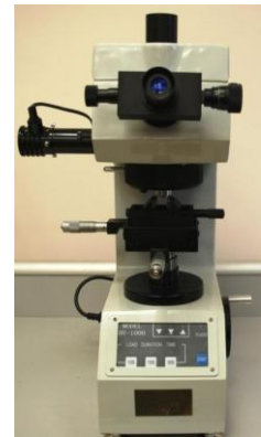
Рис. 3.1. Вимірювання знос дозуючого диска и Рис. 3.2. Твердомір моделі ущільнювальної прокладки Сівалки «Kuhn» HV -1000 Planter II.
