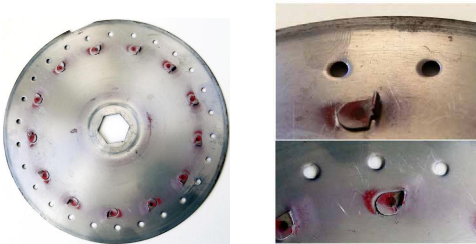
Рис. 2.5. Зношені присмоктувальні отвори дозуючого диска
