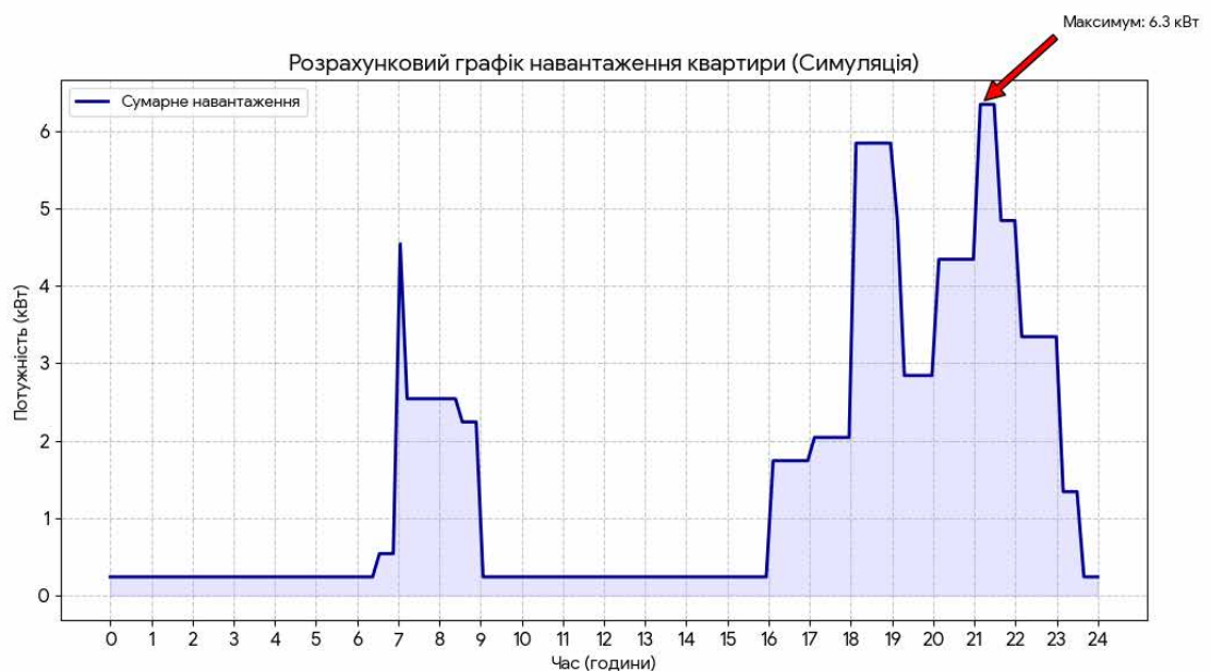
Рис. 2.1. Типовий добовий графік електричного навантаження сучасної квартири.
