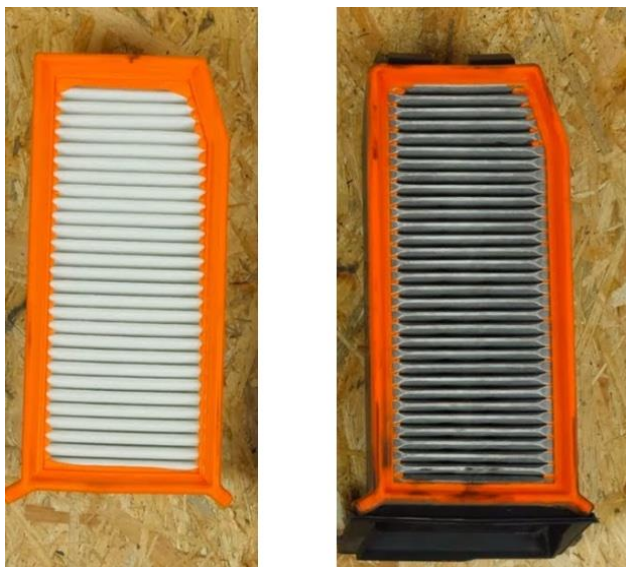
Рис. 4.1: а – новий повітряний фільтр Renault, б- відпрацьований повітряний фільтр Renault
