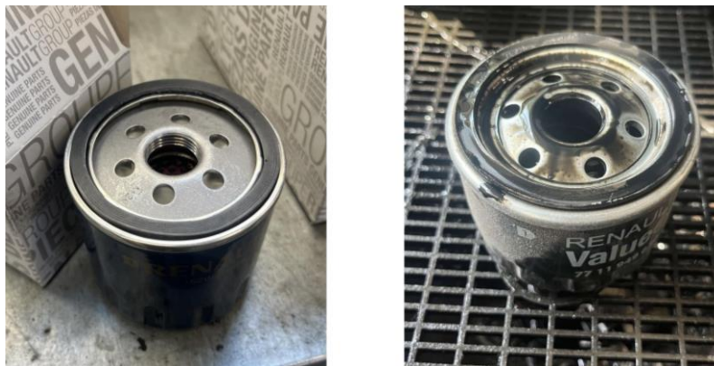
Рис. 4.3 а – новий оливний фільтр Renault Value+, б- відпрацьований оливний фільтр Renault Value+
